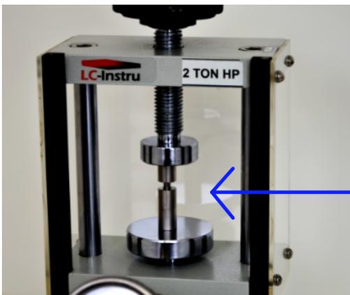
Avec Kit moule haute dureté 5 mm P max 4 T.
